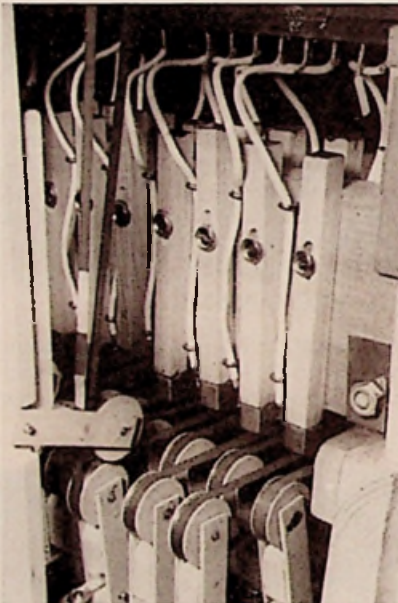
Boven: Close-up van de afschermhuis, waarin de rail, waarop alle koppes zijn aangesloten, loopt. De plug is met de ingang van de voorversterker verbonden.
